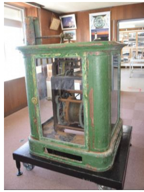
【二重円筒構造の灯塔内部と分銅自動巻揚装置】
